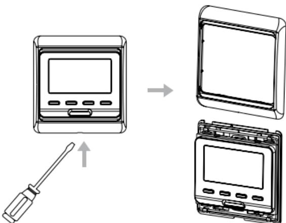
b) При помощи отвертки снимите заднюю крепежную пластину, как показано на рисунке.
