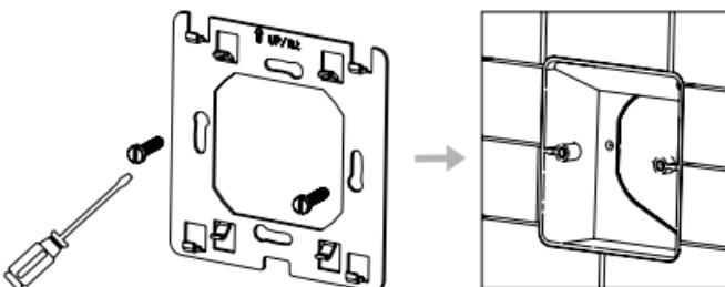
д) После подключения терморегулятора к проводам, закрепите прибор на крепежной пластине и наденьте лицевую панель и рамку.
